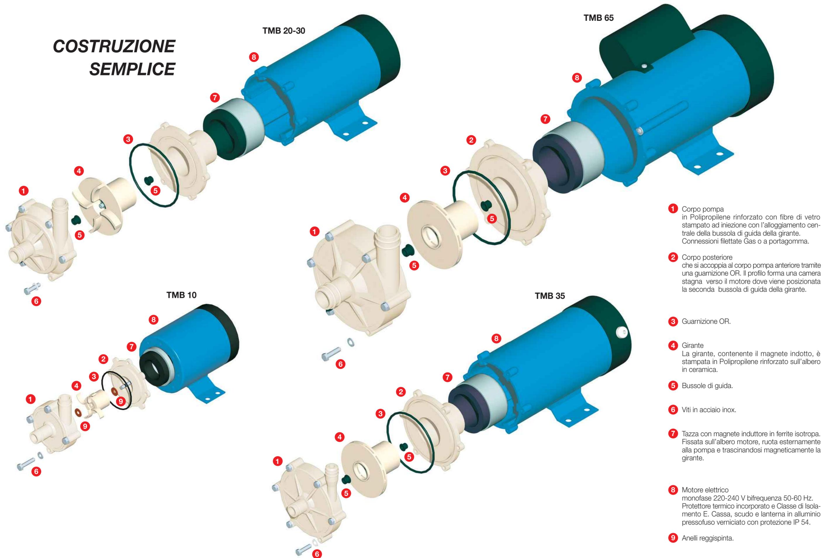
**1** Corpo pompa in Polipropilene rinforzato con fibre di vetro stampato ad iniezione con l'alloggiamento centrale della bussola di guida della girante. Connessioni filettate Gas o a portagomma.
